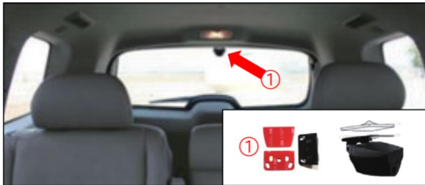
**[ 실내 설치 ]** 차량 내부에 카메라를 장착하려면, 실내 브라켓을 선택하여 뒷 유리에 장착하십시오.
